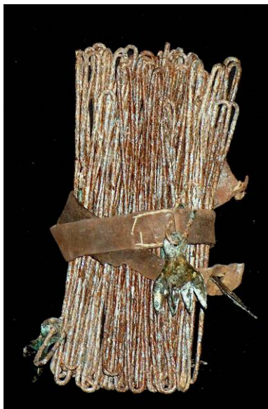
22. CADEIA DE AGRIMENSOR. Conjunto de seis cadeias, em ferro, de diferentes tamanhos (561 cm; 486 cm; 349,5 cm; 315,5 cm; 192 cm e 87,5 cm), empregue na medição de grandes áreas de terreno. Séc. XIX.
