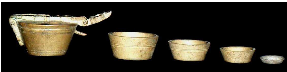
39. CAIXA. Pequena caixa, em metal gravada, contendo uma colecção de pesos de forma troncónica encaixados uns nos outros. Séc. XIX [?].
