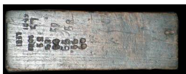
20. PÉ. Medida de comprimento (33 cm), em madeira, destinada à medição da sola do calçado e com marcas de aferição camarária desde 1811 a 1858. Séc. XIX.
